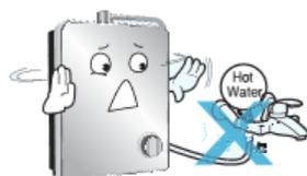
Không được lắp đường ống thoát nước axit cao hơn máy. Giữ độ dài dưới 1.5 m và không nhúng đầu ống nước thải axit ngập dưới nước
